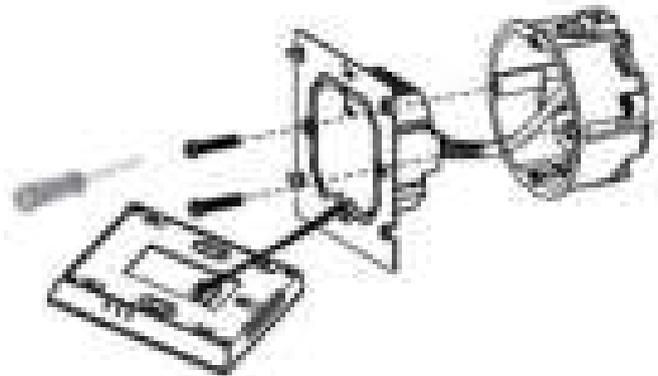
(2) Collega i cavi di alimentazione secondo lo schema di cablaggio!
