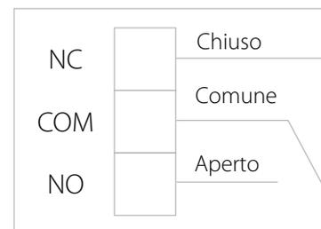
**Info:** Per le caldaie a gas, si prega di utilizzare i morsetti NO e COM (il morsetto NC è riservato alle caldaie speciali).
