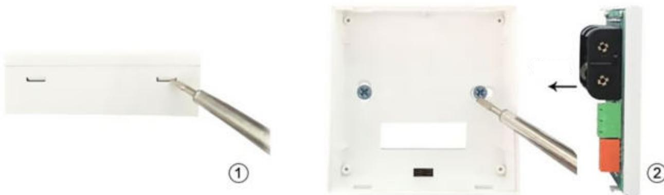
**Passo 2)** Fissa il supporto del termostato utilizzando due viti e un cacciavite, seguendo lo schema qui sotto!
